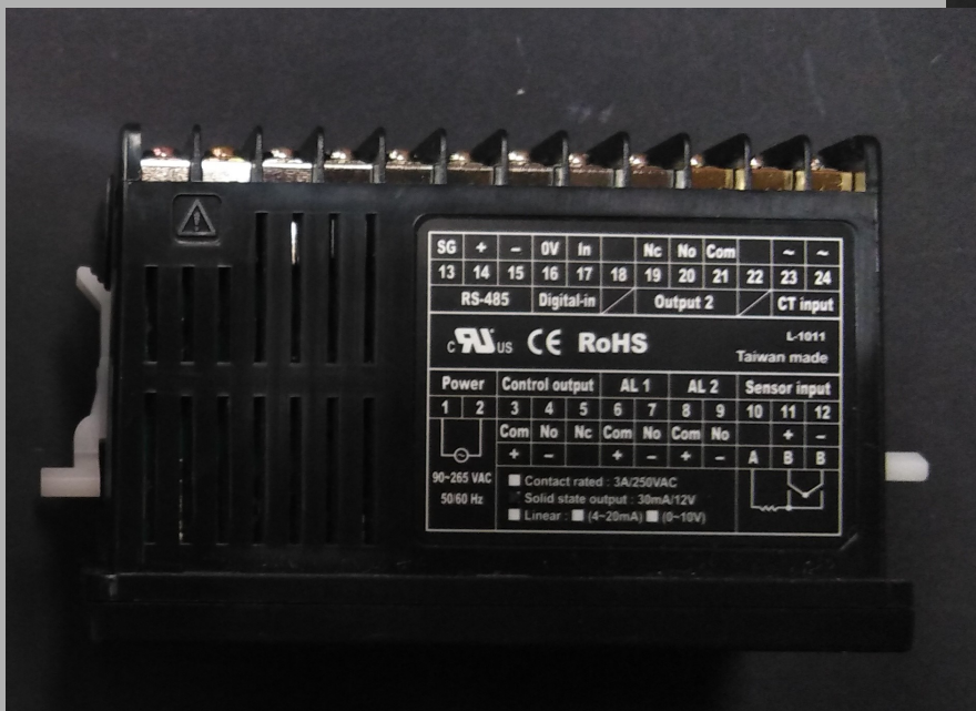
CONTROLADOR DE TEMPERATURA (PIROMETRO) REF: NT-20V
