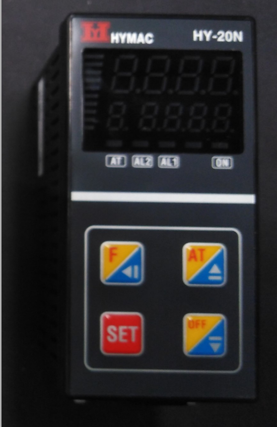
CONTROLADOR DE TEMPERATURA (PIROMETRO) REF: MT20-V ➔
